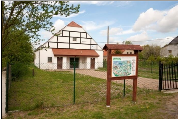
OS_WN3a Świetlica wiejska. „Karykatura” typowego budynku zagrodowego. Rażą proporcje i atrapa konstrukcji szachulcowej.
